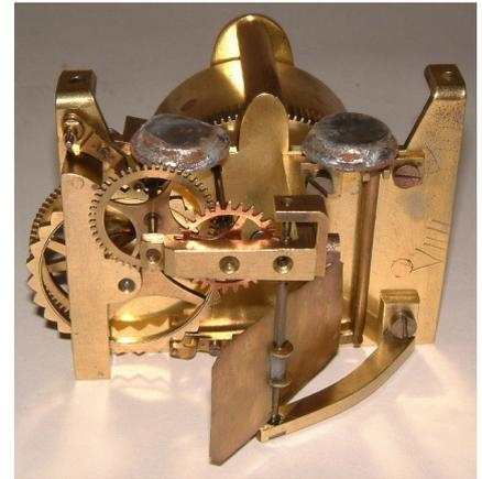
Der 15'' Argandbrenner steckt mit einem schlanken Konus im Hals der Lampe. Auch die Platzierung des Dochtschlüssels ist anders als bei anderen Carcellampen. Der Schlüssel wird in einer Bohrung in einem der Brennerstege geführt, bevor er in das Vierkant des Zahnrades eingreift.
