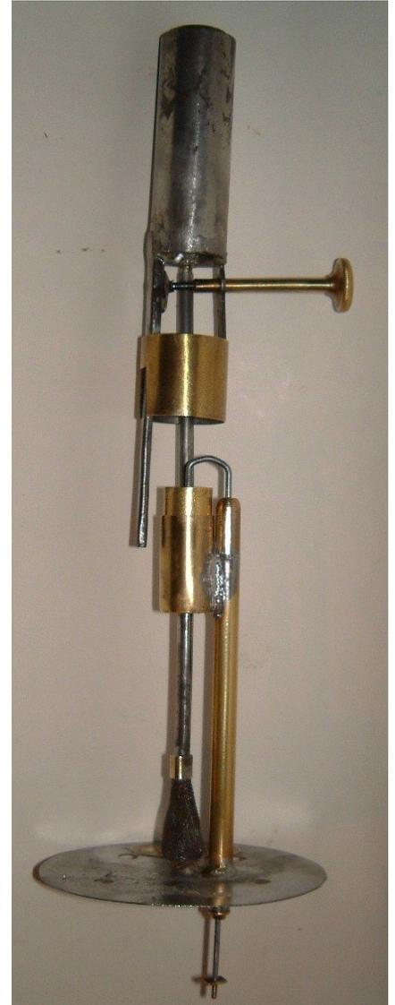
Jedoch durch die Hubbewegung ist eine Abdichtung schwierig, da bei einer guten Abdichtung ein hoher Kraftaufwand erforderlich ist. Die Hubbewegung des Kolbens kann bis zu 20 mm betragen, was von der Einstellung am Federwerk abhängig ist. Jedoch ist bei der Einkolbenpumpe eine kurze und schnelle Hubbewegung wahrscheinlicher, da sonst beim Saugvorgang die Flamme zu weit zurückbrennt, ja sogar erlöschen kann.
