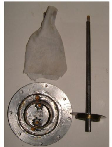
Geöffnete **Pumpe** von oben. Im Bodendeckel zu erkennen sind die Aufnahmen der beiden Druck- und Saugventile. In der Mitte befinden sich die Druckventile, im Außenkranz die beiden Saugventile. Das daneben liegende Steigrohr wird mit Gewinde in den Mittelkranz eingeschraubt. Dieses Mittelteil bildet auch die Vorkammer, in der durch das eingepumpte Öl die Luft komprimiert wird.
