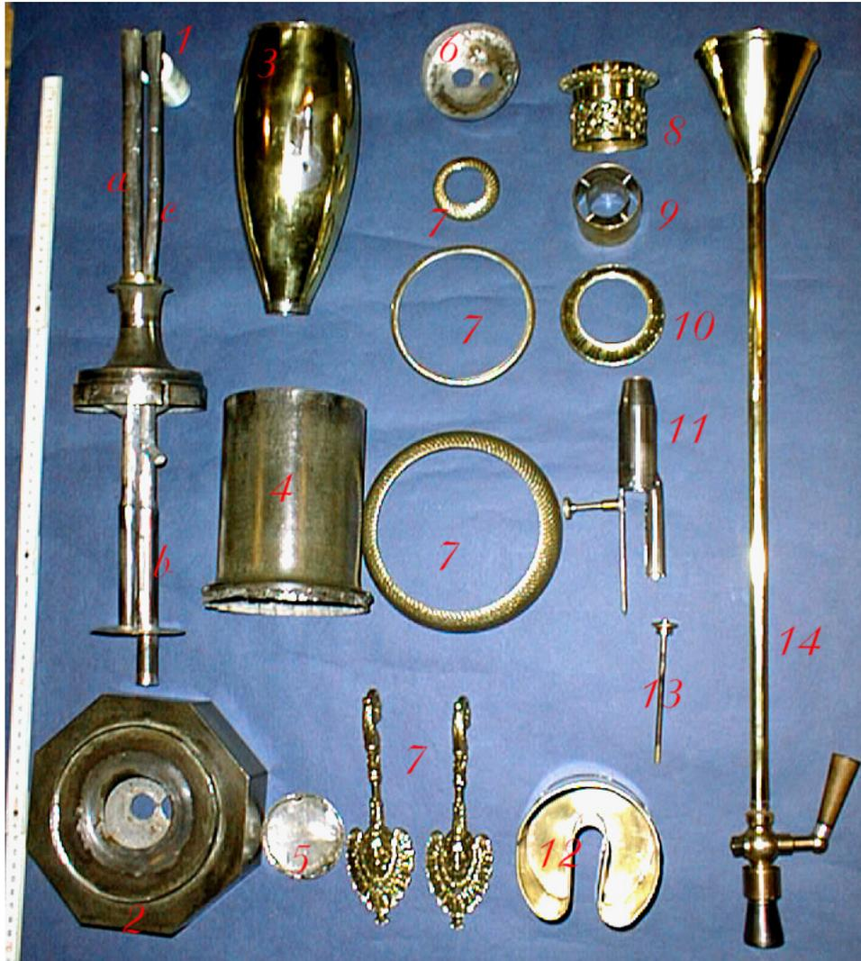
1. Rohrsystem, a = Steig – und Füllrohr, b = Druckrohr, c = Überlaufrohr
