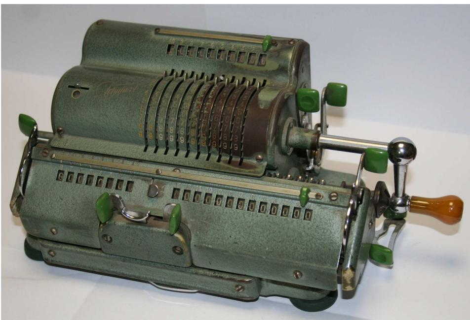
Das Modell „Schubert“ ist baugleich mit der Kurbelmaschine „Facit“.
