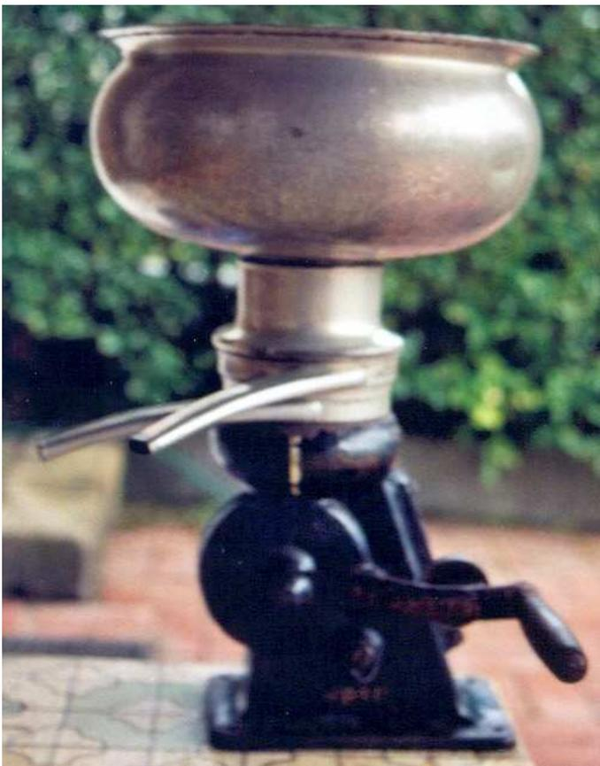
Im Bild die im Heimatmuseum vorhandene Milchzentrifuge, gut erhalten und noch voll funktionsfähig. Das Maschinenteil ist aus Guss. Aufgebaut hat die Zentrifuge eine Höhe von 44,5 cm, der Milchbehälter ist 27,5 cm im Durchmesser, 14 cm hoch und hat ein Fassungsvermögen von 5 Litern. Diese Milchzentrifuge für Handbetrieb wurde dem Heimatmuseum Wemmetsweiler kostenlos übergeben. Im Heimatmuseum sind drei unterschiedliche Zentrifugen vorhanden.
