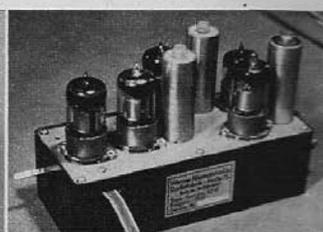
Gesonderter UKW-Vorsatz mit 4x EF 174 und EA 171 in Ratiodektorschaltung. Einbaugerät für Empfänger und Musiktruhen der Firma Niemann, Halle
