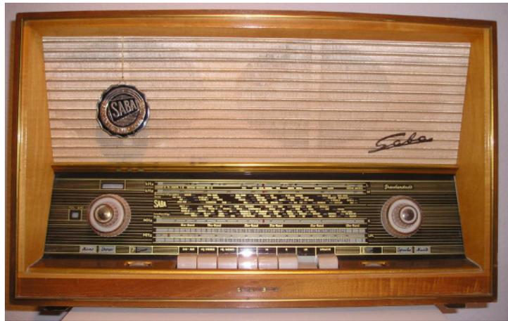
*Typischer Vertreter der 50er Jahre Empfänger mit sehr schönem Klang. Das Radio ist mit insgesamt 4 Lautsprechern ausgestattet und besitzt eine Gegentaktendstufe mit 2 Röhren EL95. Der damalige Preis betrug stolze 429DM. Die Firma Saba fertigte in den 50er Jahren eine große Vielfalt an Radiomodellen mit teilweise sehr aufwendiger Technik, z.B. das Modell Meersburg Automatic mit Sendersuchlauf, der mit Motoren realisiert wurde.*
