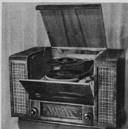
Rema-Fonosuper „Symphonie“ mit einem 10-Plattenwechsler der Firma Hummel & Seifhüs, Dresden, ein 10-(10)-Kreis-AM/FM-Super. In dem Gerät sind die neuen Gnom-Röhren von RFT verwendet. UKW-Teil mit HF-Vorröhre und eine KW-Bandspreizung
