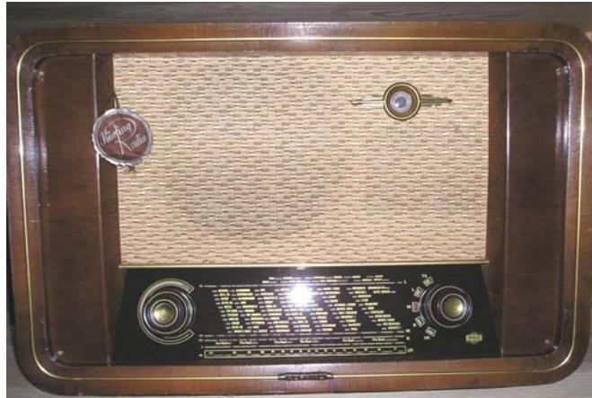
*Allstromgerät noch aus der Zeit der drucktastenlosen Radioempfänger (nur Drehknöpfe zur Bedienung. Das Radio wurde in diesem schönen Erhaltungszustand vom Radiomuseum Berlin erstanden (Inventaraufkleber auf der Rückseite). Selten ist auch der Garantiewimpel an der Lautsprecherfront. Der Empfänger ist unrestauriert und spielbereit.*
