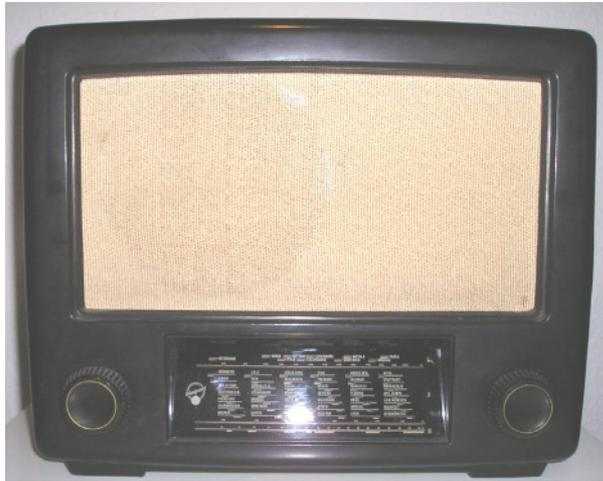
*Allstromempfänger mit U-Röhren im Bakelitgehäuse. Das Radio hat Lang-, Mittel- und Kurzwelle. Das Gerät ist restauriert und funktionstüchtig.*
