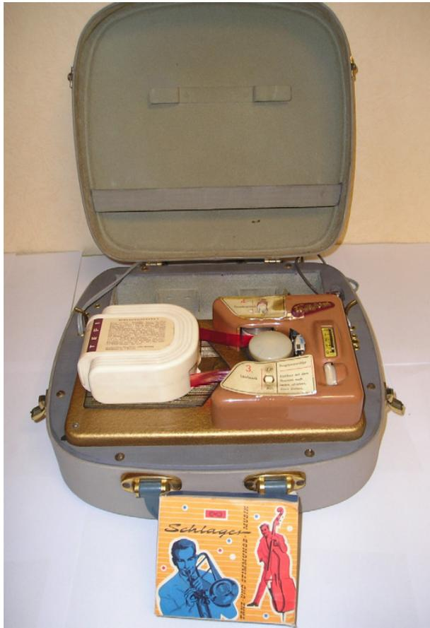
Das Tefifon wurde von der Firma Tefi-Apparatebau in den 30er Jahren entwickelt und wurde ab 1951 angeboten. Verwendet wurde eine Schallbandkassette mit einem 2cm breiten und ca. 30m langen Band. Das Schallband ist mit Rillen, ähnlich wie bei der Schallplatte, versehen. Die Abtastung geschieht wie beim Plattenspieler mittels Nadeltonkopf.
