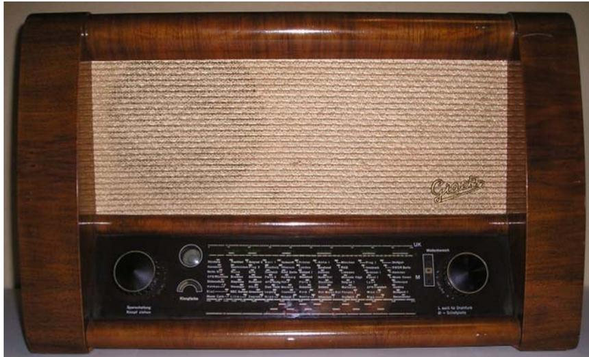
Radio mit E-Röhrenbestückung: ECH42, 2 X EAF42, EL11, EM4
