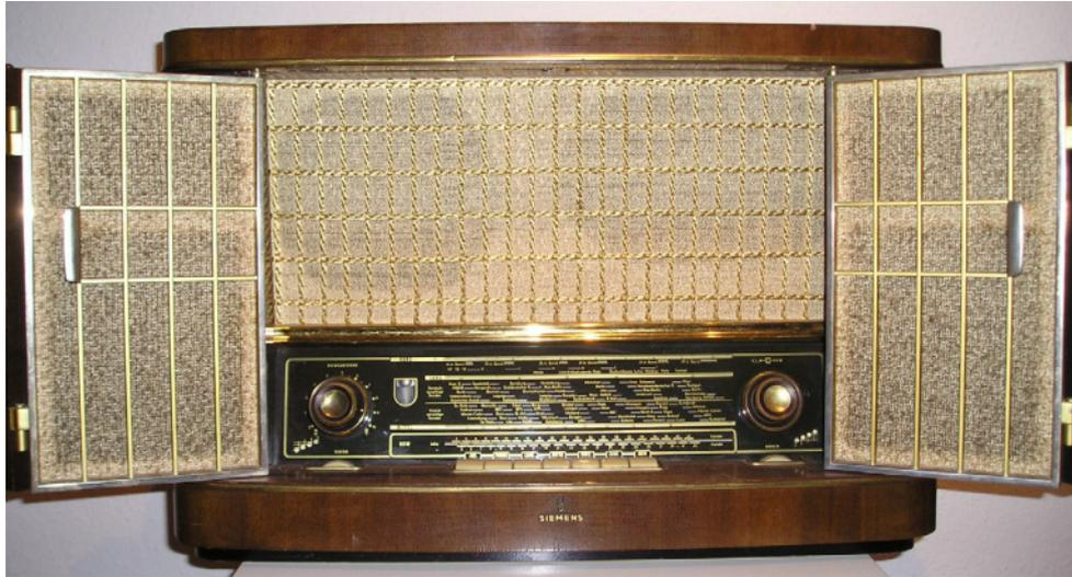
6 Kreis (AM) / 9 Kreis (UKW) Empfänger mit E-Röhrenbestückung. Das Radio zeichnet sich durch sein besonderes Design aus. Die vorderen Türen lassen sich aufklappen und geben die dahinterliegenden Bedienelemente frei. Die Siemens Schatullen sind durch ihren guten Klang bekannt. Dieses Exponat ist das kleine Modell von Siemens mit „nur“ 2 Lautsprechern. Das Radio befindet sich im spielbereiten Originalzustand. Damaliger Preis: 399DM!
