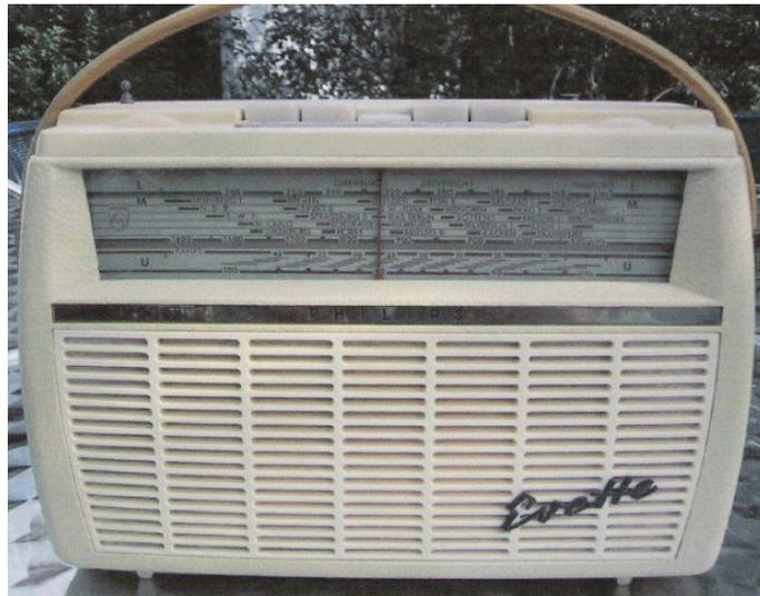
Kofferradio aus den 60er Jahren, schon komplett mit Transistoren gefertigt. In den 60er Jahren kam diese Art der Radios immer mehr in Mode. Man konnte Sie im Gegensatz zu Geräten mit Röhren auch bequem mit normalen Batterien betreiben, was diese Radios sehr mobil machte (ideal fürs Picknick oder Ausflug am Wochenende).
